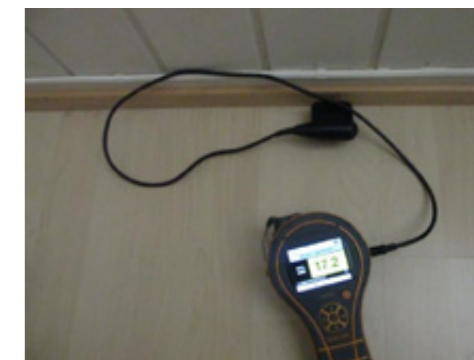
Fuktmåling langs sørveggen i kjellaren.
