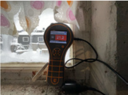
Bilder viser fuktmåling i kjellervindu.
